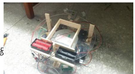
小(即前方有垃圾擋住)，就開啟電源使馬達作正轉，再反轉電源使馬達做反轉，然後再斷電停下。這樣每當行經路線的前方有垃圾時，就可以自動鏟起並自動收回。不過這樣的話推鏟的馬達要用外接電源，會比較麻煩一些。也希望未來如果可以把程式語言學得更專精的話，可以用程式讓其他馬達也達成半自動的運作模式。
