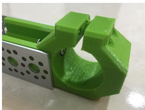
這是我們用 3D 印表機製作的馬達固定座，可以調整三個固定位置，改變機器人的輪軸長度
